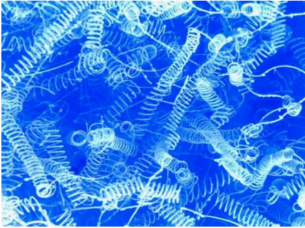
マイクロコイル状 \text{Si}_3\text{N}_4 ファイバー(日本セラミックス協会、セラミックスに関する顕微鏡写真展、入選(最優秀賞)、1988)
