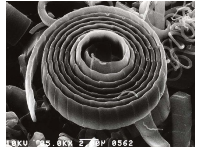
同心円状のカーボンマイクロコイル(日本セラミックス協会、セラミックスに関する顕微鏡写真展、入選(優秀賞)、2000年)
