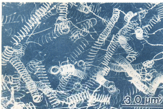
図1 鉄不純物により成長したコイル状窒化ケイ素ファイバー (H. Iwanaga, et al.: J. Mater. Sci. Lett. 9 (1990) 731 より転載)
