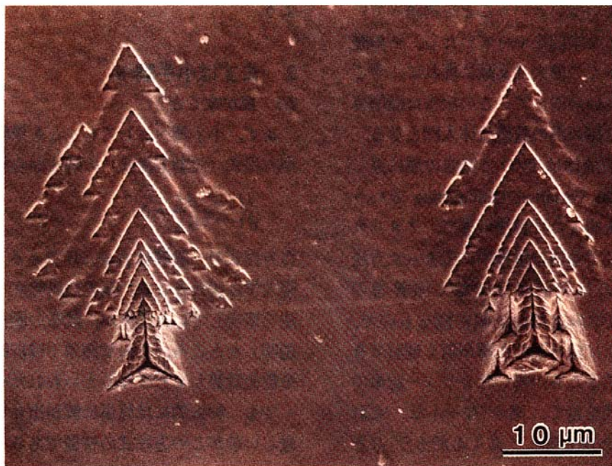
クリスマスツリー状の腐食模様
