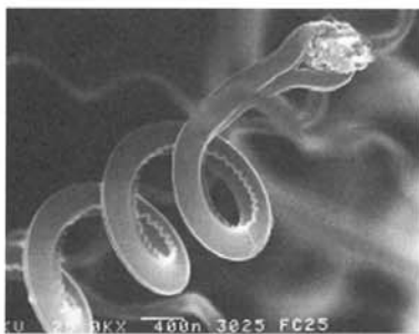
図15 シングルコイルの先端部分 (先端中央部の白い部分は触媒粒)
