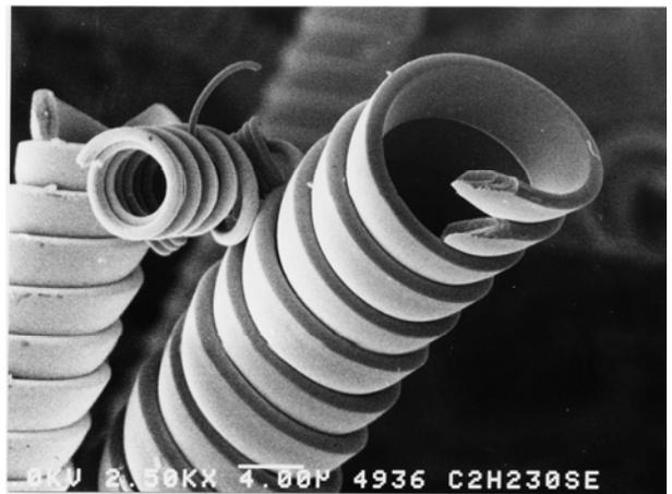
写真3 規則性(扁平)二重コイル(ファイバー断面が扁平)の破断面
