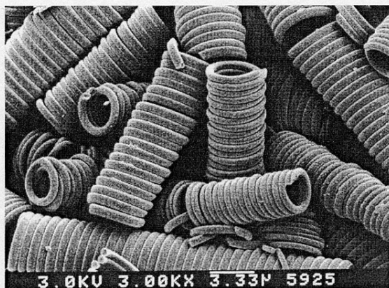
図1 粉末化したCMCの代表的なSEM写真
